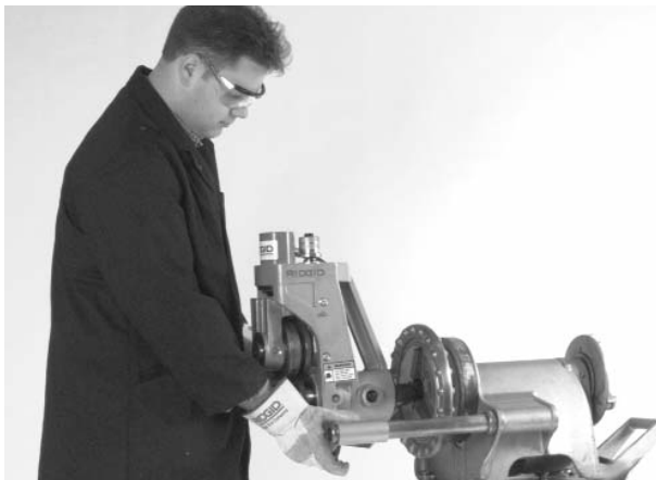
Figure 2 – Montage sur moteur d'entraînement n° 300
