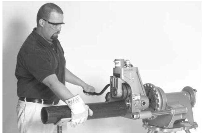
Figure 16 – Eloignement du tuyau lorsque le moteur d'entraînement tourne en marche arrière (REV)
