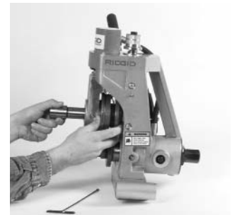
Figura 18 – Se extrae el eje de retención y el rodillo ranurador
