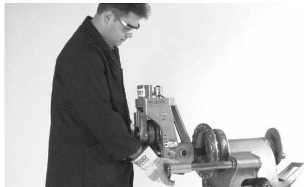
Figura 2 – Instalación del Accionamiento Propulsor No. 300
