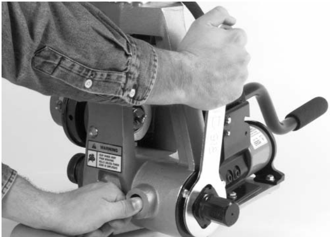
Figura 19 – Oprima la clavija de enclavamiento del huso y extraiga la tuerca de retención del árbol de transmisión con una llave de dado
