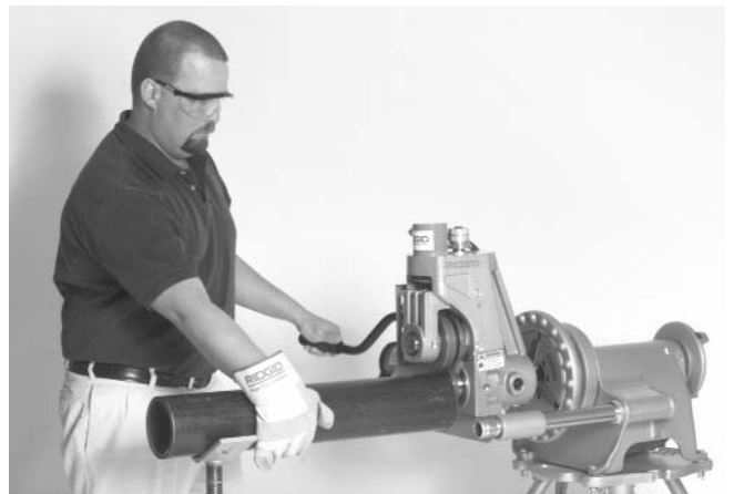
Figura 16 – Operario ejerce presión hacia él, con su mano derecha sobre el tubo, cuando el Accionamiento Propulsor está en la modalidad REV (reversa).
